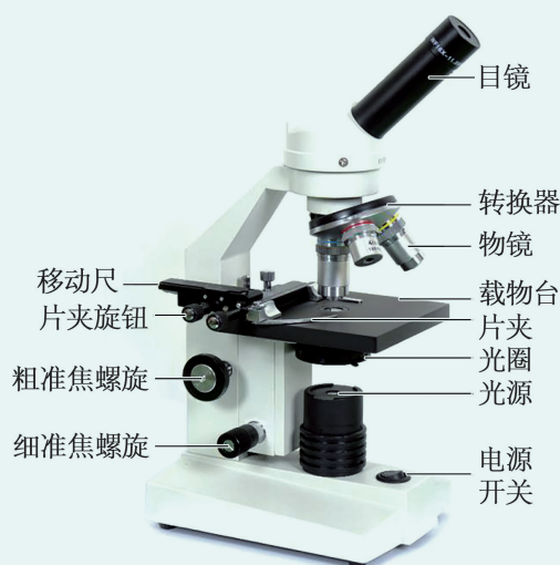
图 1-8 光学显微镜构造示意图
