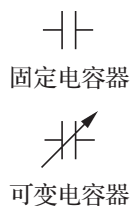
图 9-48 电容器的符号
