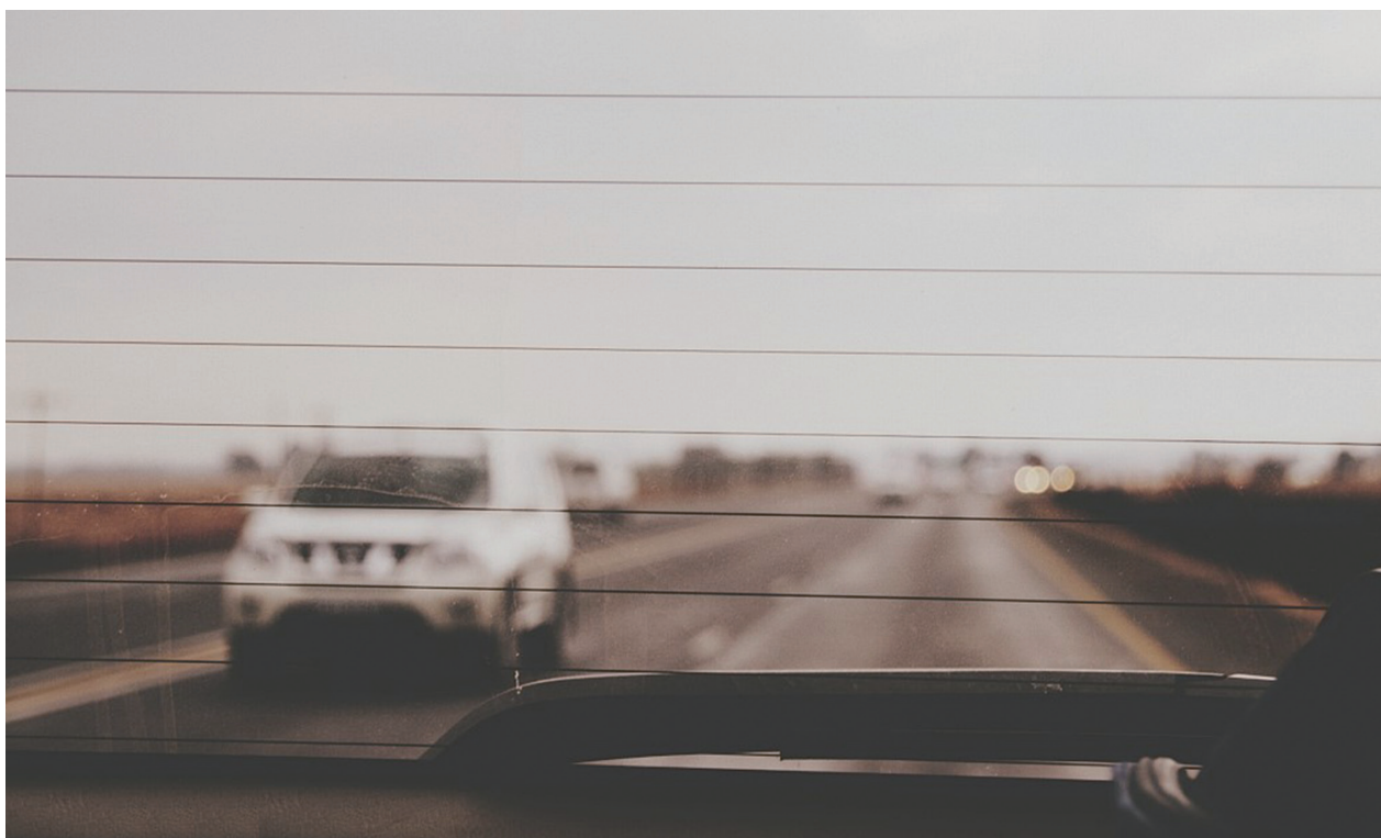
图 10-20 汽车后挡风玻璃上的电阻丝
