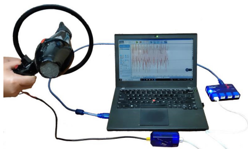
图 11-36 用微电流传感器检测电磁波
