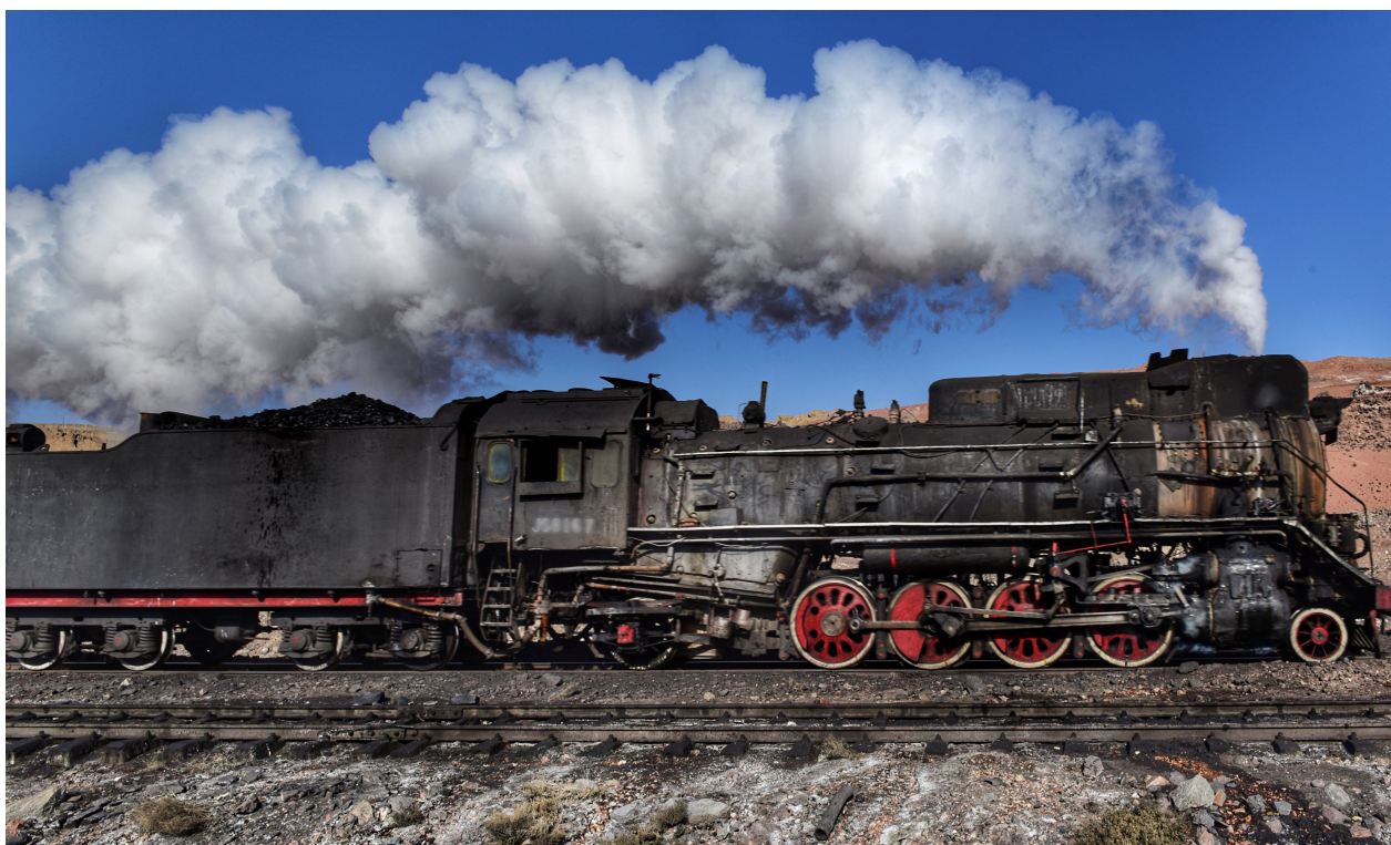
图 12-10 蒸汽机车将内能转化为机械能
