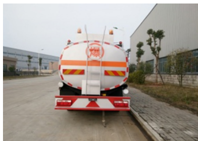
(a) 油罐车尾的拖地链
