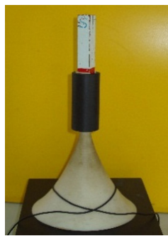
图 11-28 沿着特殊圆锥外曲面向上滑动的闭合回路
