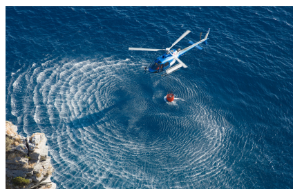
图 4-22 悬停在空中的直升机螺旋桨向下推空气
