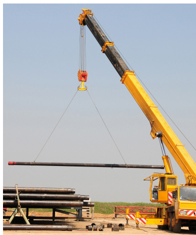
(a) 起重机用钢绳吊起钢材
