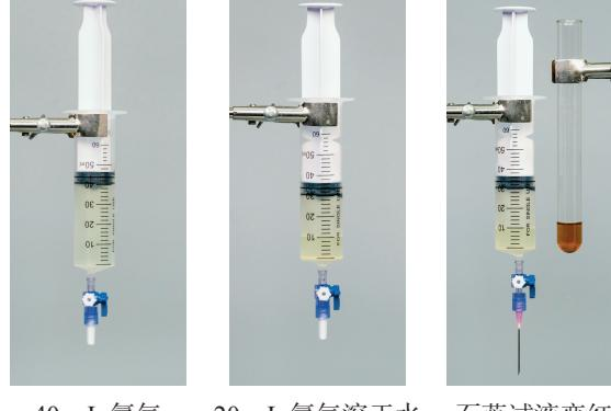
40 mL 氯气              20 mL 氯气溶于水              石蕊试液变红
