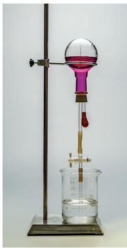
图 3.11 氨的“喷泉”实验
