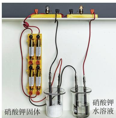
图 2.12 物质导电实验装置
