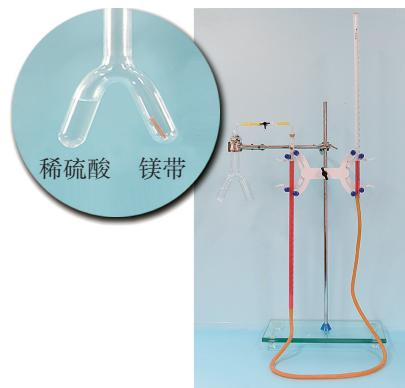
图 1.31 化学反应气体体积测定装置
