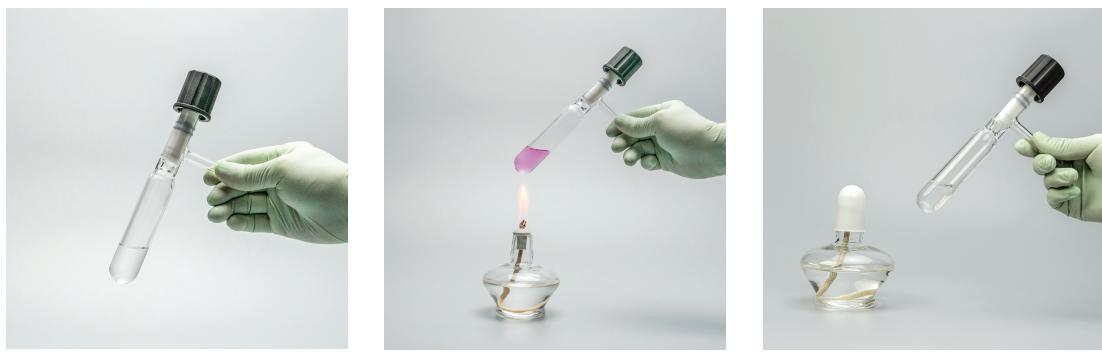
图 3.3 溶有二氧化硫的品红试液加热后再冷却
