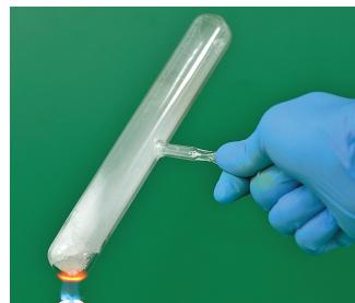
图 3.13 氯化铵受热分解
