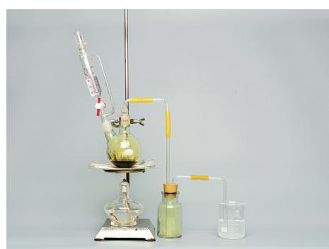
图 1.15 实验室中制备氯气的装置
